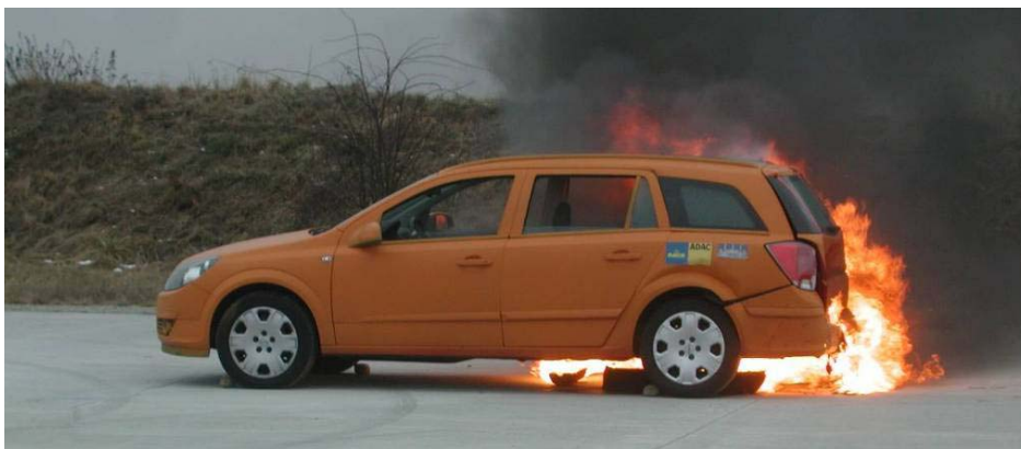
Figura 8: la gasolina de las bandejas se ha incendiado.
